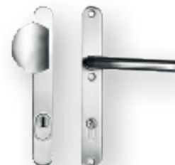
Griffgarnitur Victoria Außendrucker: SKG***, Edelstahl matt mit Kernziehschutz, 32 / 250 mm, Tiefe 60 mm, Innendrucker: 32 / 250 mm, Tiefe 70 mm, Art.-Nr. 1773-01
